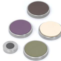
Reference Blocks Quick self-verifacaton acc. DIN EN ISO 48
