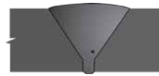
39 Porosity in Fillet (sub-surface) UT, RT
