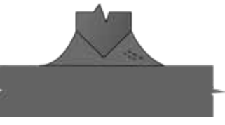
31 Porosity in Fillet (sub-surface) UT, RT
